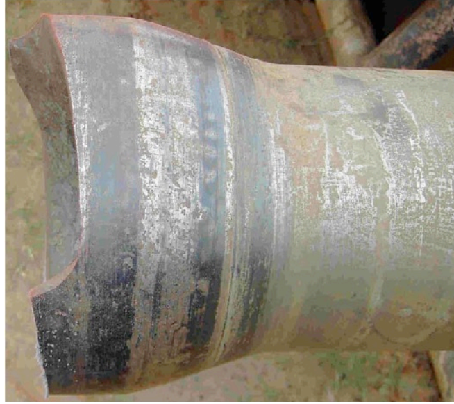
الشكل 16: انقطاع وصلة أنبوب الحفر نتيجة الاحتكاك
